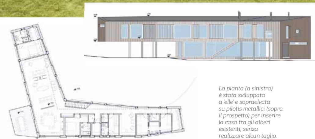
La pianta (a sinistra) è stata sviluppata a 'elle' e sopraelevata su pilotis metallici (sopra il prospetto) per inserire la casa tra gli alberi esistenti, senza realizzare alcun taglio.
